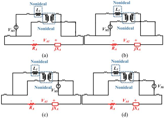
Fig. 14. Radiation model due to each equivalent voltage source. (a)  $V_{M1}$ . (b)  $V_{M2}$ . (c)  $V_{M3}$ . (d)  $V_{M4}$ .
